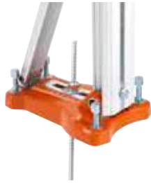
2 Systèmes d'ancrage pour fixation dans des matériaux abrasifs
