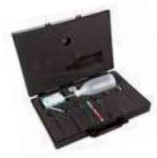
6 Test de pénétration, Karsten Pipe test kit
