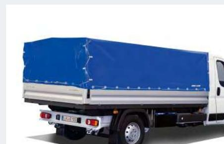
Planen / Spriegelaufbau ohne Boxenintegration (Normaldach)
