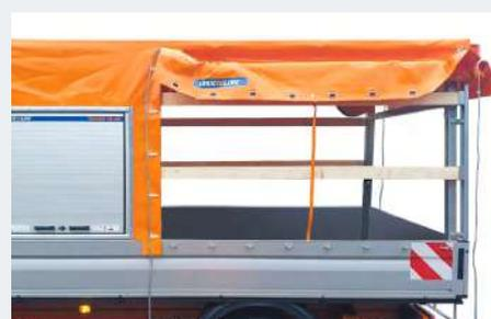
seitlicher und / oder heckseitiger Planenlift\* zum schnellen und unkomplizierten Öffnen und Zugreifen
