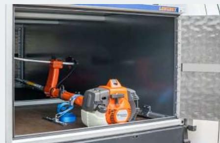
Querverstrebung in der Mitte schützt Ladung vor Verrutschen, schwere Einzelgüter ab 20 kg sind kraftschlüssig zu sichern, z.B. mit Zurrset für Gefahrgut\*
