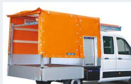
CombiCover (S. 16) bietet alle Vorteile des CombiRacks sowie Schutz vor Witterung und Verschmutzung; Transportboxen integrierbar
