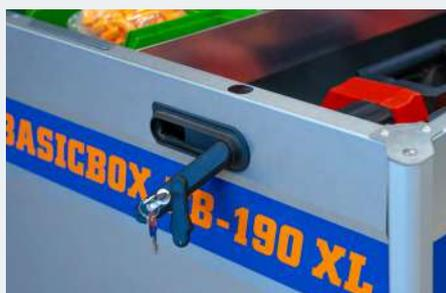
optionaler Schwenkebelverschluss\* mit Profilhalbzylinder statt standardmäßigem Drehriegelverschluss mit Knebelgriff und Rundzylinder
