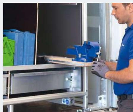
ausziehbarer Schraubstock\* für eine mobile Werkbank
