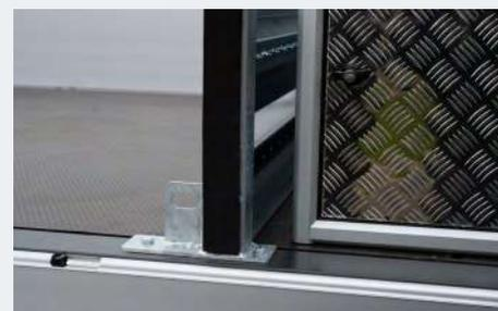
bei direkter Montage des Ladeflächenteilers an eine Transportbox entsteht aufgrund der Fußkonsole ein Abstand von 35 mm
