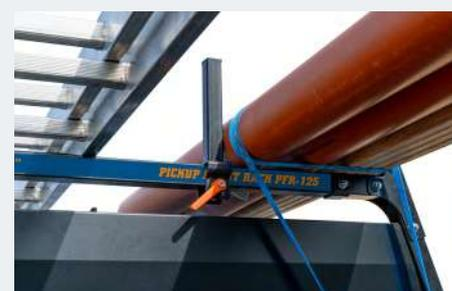
flexibler Formschluss durch unseren Lastenstopper mit Klemmhebel\* möglich
