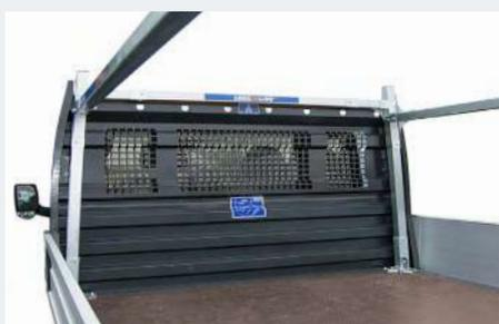
PowerRack auch bei Ford Transit möglich: Montage hinter / zwischen dem werkseitigen Fahrerhausschutz
