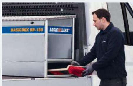
versperrender Stauraum\* für langstieliges Werkzeug, Zugriff und Beladung von beiden Fahrzeugseiten
