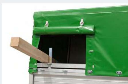
heckseitige Ladeluke\* für schrägen Langguttransport; inklusive abnehmbarer Lastenauflage
