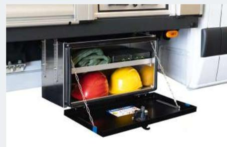
Box mit umlaufender Dichtung; Deckel bis 90° mit Fangkette zu öffnen
