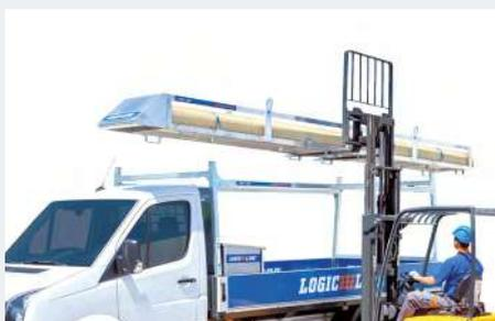
LongRack kann mit Stapler oder Kran auf das PowerRack geladen bzw. auf das Dach gehoben werden
