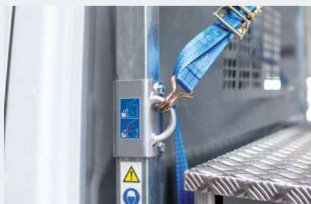
frei positionierbare Zurrkonsole\* zur kraftschlüssigen Ladungssicherung
