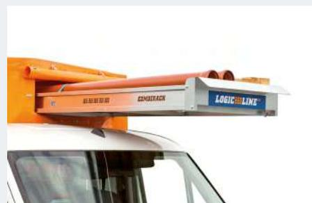
integriertes Formschlussblech vorne für formschlüssige Ladungssicherung
