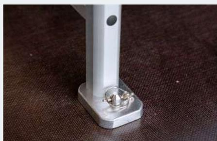
Schnellmontagesystem\* zur einfachen, werkzeuglosen Montage und Demontage der Box auf der Pritsche
