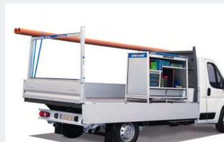
HR-200 kombiniert mit werkseitigem Fahrerhauschutz und Toolbox; Hinweis: Diese Variante ohne FrontRack Adapter ist nicht bei allen Fahrzeugen möglich, wir beraten Sie gerne.
