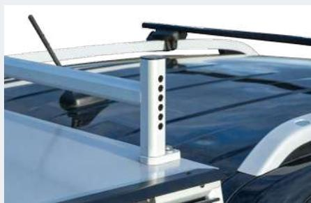
PS-200 mit Auflagebügel und Dachträger zum einfachen Transportieren von Langgut, Detailansicht
