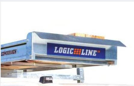
integriertes Formschlussblech vorne für formschlüssige Ladungssicherung
