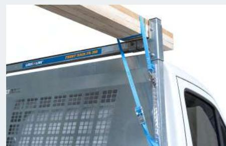
vertikale Zurrschienen\* am Beispiel FR-200 zur vertikal variablen Positionierung von Zurrpunkten
